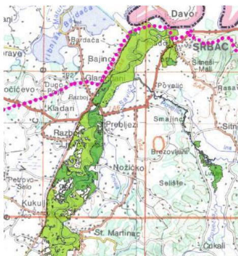
Slika 5.2.1.2. Prikaz rizika od poplava po ekonomiju i privredu na slivu rijeke Vrbas u opštini Srbac, za velike vode godišnje računске vjerovatnoće prevazilaženja p=5\% kanala
