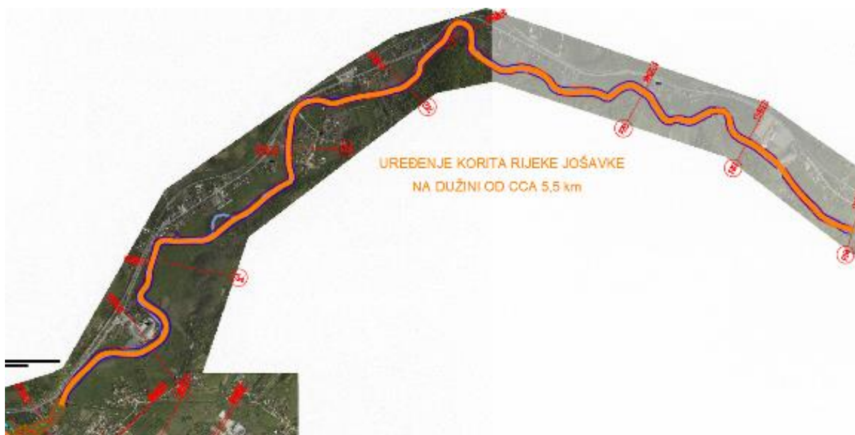
Slika 5.4.2.4.3. Dispozicija idejnog tehničkog rješenja uređenja korita r. Jošavke u Čelincu u dužini od 5,5 km
