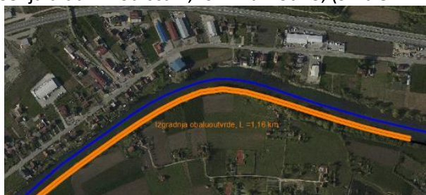
Slika 5.4.2.2.1. Dispozicija tehničkog idejnog rješenja - produženje obaloutvrde na uzvodni potez - lokalitet Šušnjari u dužini od 1,16 km
