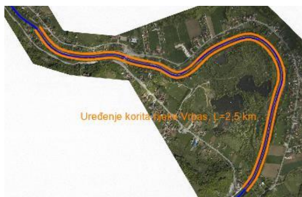
Slika 5.4.2.3.1. Dispozicija idejnog tehničkog rješenja planiranog uređenja korita rijeke Vrbas u naselju Karanovac u dužini od 2,7 km
